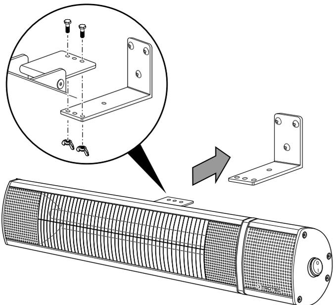
8. Drehen Sie das Gerät in den gewünschten Neigungswinkel. Das Gerät ist um 90° nach oben und unten verstellbar. Fixieren Sie den Neigungswinkel mithilfe des Innensechskantschlüssels.
