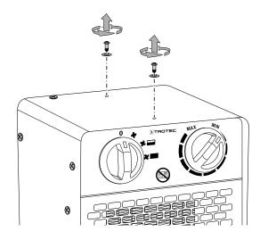
Montieren Sie den Transportgriff mit den Schrauben und Unterlegscheiben.
