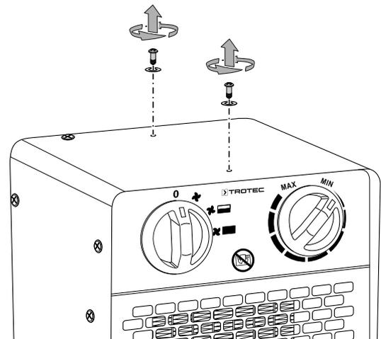
2. Montez la poignée de transport au moyen des vis et des rondelles.
