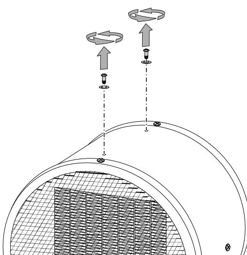
2. Ručku za transport montirajte vijcima i podložnim pločicama.
