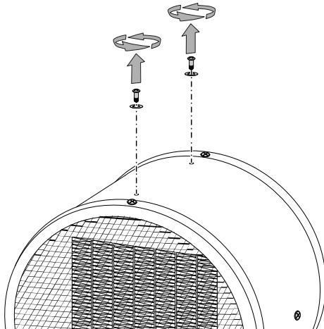
2. Monter transporthåndtaket med skruene og underlagsskivene.
