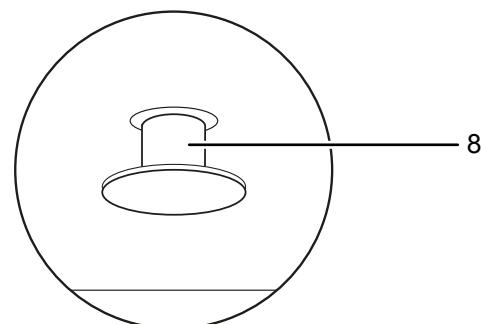
Uredaj se može rabiti tek kada se sklopka za zaštitu od prevrtanja potpuno gurne u uređaj. To se događa automatski kada uređaj postavite na prikladnu podlogu.
