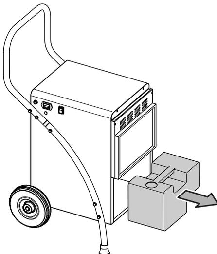
2. Vacíe el depósito de agua condensada en un desagüe o un fregadero.
