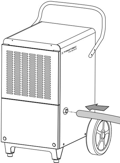
7. Conecte el otro extremo de la manguera a un desagüe apropiado (por ejemplo un sumidero o un recipiente colector suficientemente grande). Asegúrese de que la manguera no se pueda doblar.
