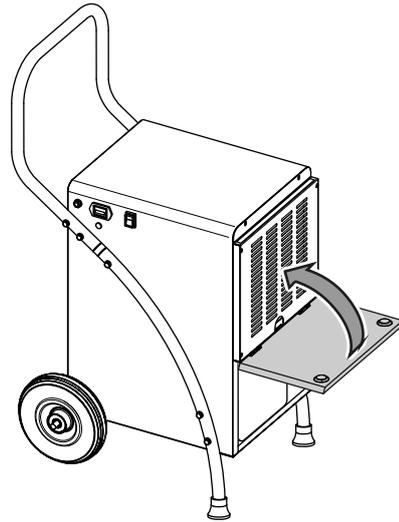
2. Extraiga el depósito de agua condensada.
