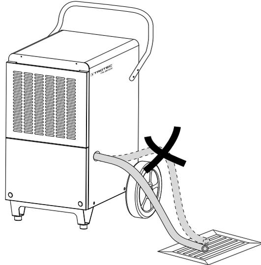
8. Cerciérese de que la manguera de descarga de agua condensada siempre tenga una caída.
