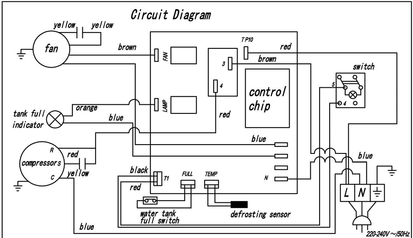
Esquema de conexiones
