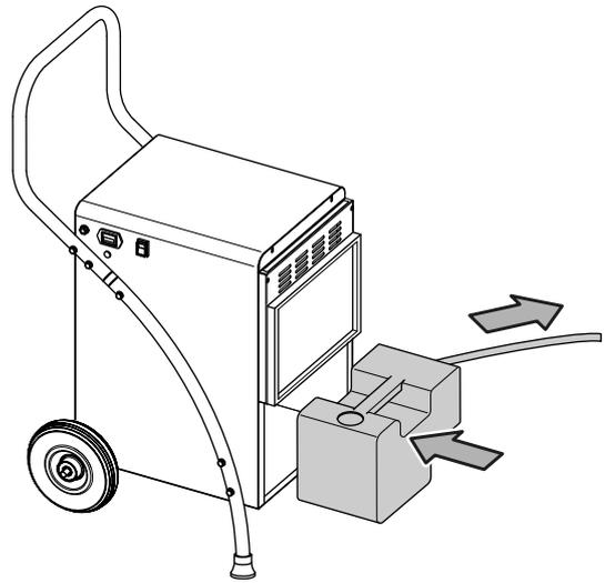
4. Conecte uno de los extremos de la manguera a la conexión de manguera del depósito de agua condensada.
