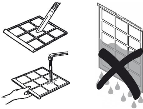
3. Deje que el filtro se seque completamente. No coloque nunca el filtro en el aparato mientras esté húmedo.
