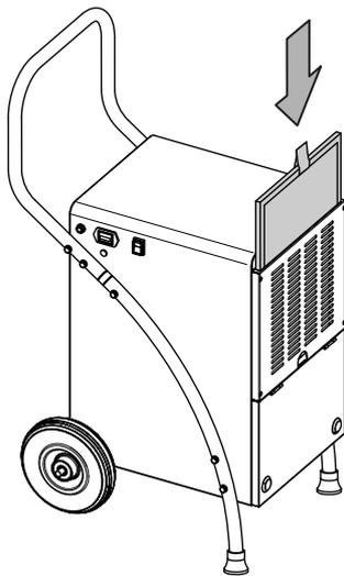
**Colocar el depósito de agua condensada**
