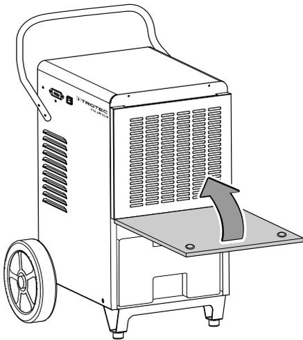
2. Extraiga el depósito de agua condensada.
