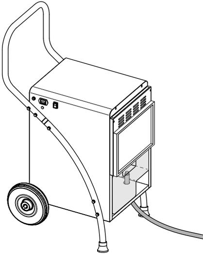
5. Vuelva a insertar el depósito de agua condensada en el aparato. Conecte el otro extremo de la manguera a un desagüe apropiado (por ejemplo un sumidero o un recipiente colector suficientemente grande).
