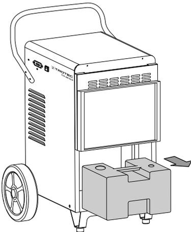
3. Branchez le tuyau d'évacuation des condensats sur le raccord situé à l'intérieur de l'appareil.
