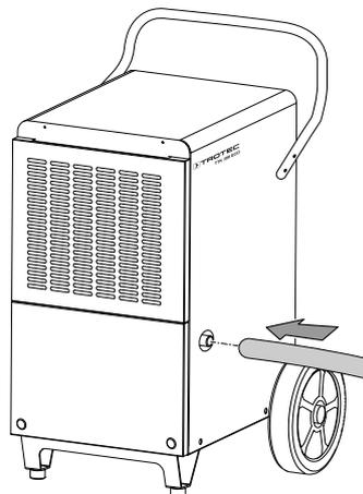
7. Placez l'autre extrémité du tuyau dans une évacuation adéquate (par exemple une canalisation ou un bac collecteur suffisamment grand). Veillez à ne pas plier le tuyau.
