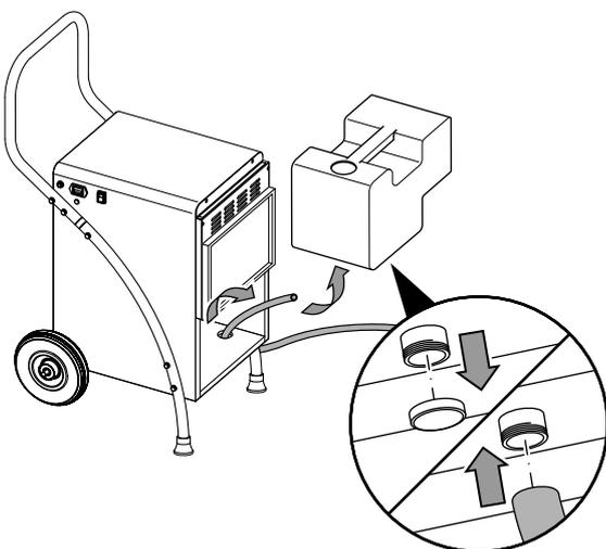
5. Insérez à nouveau le bac de récupération de l'eau de condensation dans l'appareil. Posez l'autre extrémité du tuyau dans une évacuation adéquate (par ex. une canalisation ou un bac collecteur suffisamment grand).
