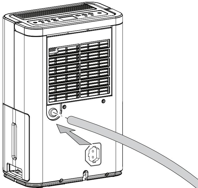
3. Før den andre enden av slangen til et egnet avløp (f.eks. utløp eller en tilstrekkelig stor oppsamlingsbeholder). Vær oppmerksom på at slangen ikke må være bøyd.
