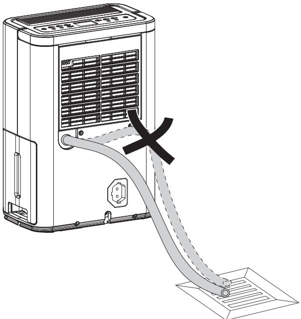
4. Fjern slangen hvis kondensen igjen skal samles opp via kondensbeholderen. La slangen tørke godt før lagring.
