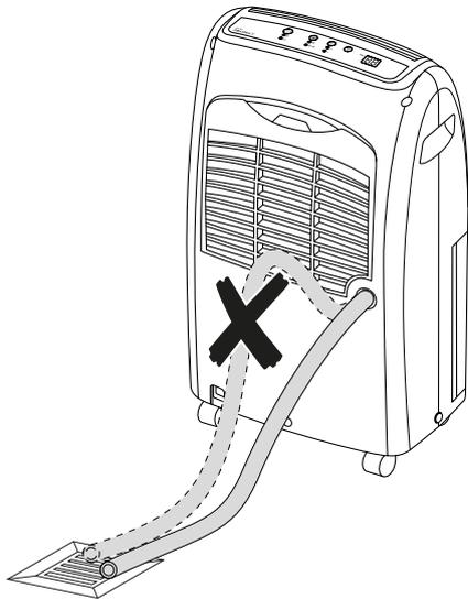
Entfernen Sie den Schlauch, wenn Sie den Kondensat wieder über den Kondensatbehälter auffangen wollen. Lassen Sie den Schlauch vor der Lagerung trocknen. Der Schlauch kann in jeder beliebigen Betriebsart zum Dauereinsatz angeschlossen werden.
