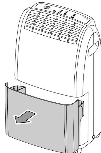
2. Entleeren Sie den Kondensatbehälter über einem Abfluss oder Spülstein.
