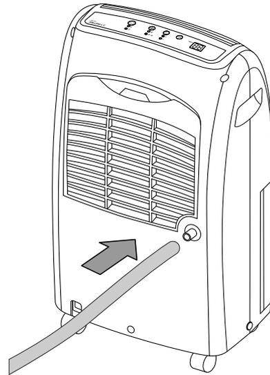
4. Überprüfen Sie, ob der Schlauch richtig auf dem Anschluss sitzt. Korrigieren Sie ggf. die Position über die Öffnung am Kondensatbehälter.
