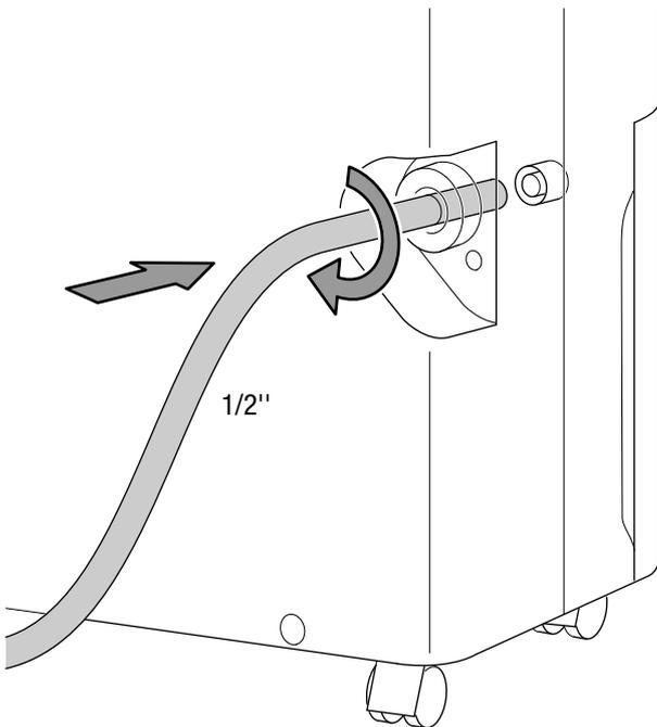
5. Führen Sie das andere Ende des Schlauches zu einem geeigneten Abfluss (z. B. Gully oder einem ausreichend großen Auffangbehälter). Beachten Sie, dass der Schlauch nicht geknickt werden darf.
