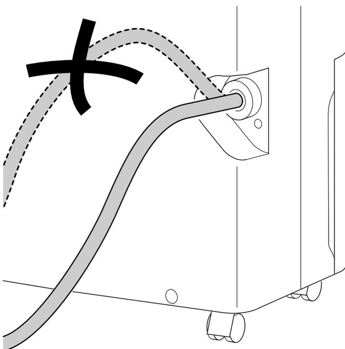
Entfernen Sie den Schlauch, wenn Sie das Kondensat wieder über den Kondensatbehälter auffangen wollen. Lassen Sie den Schlauch vor der Lagerung trocknen. Der Schlauch kann in jeder beliebigen Betriebsart zum Dauereinsatz angeschlossen werden.
