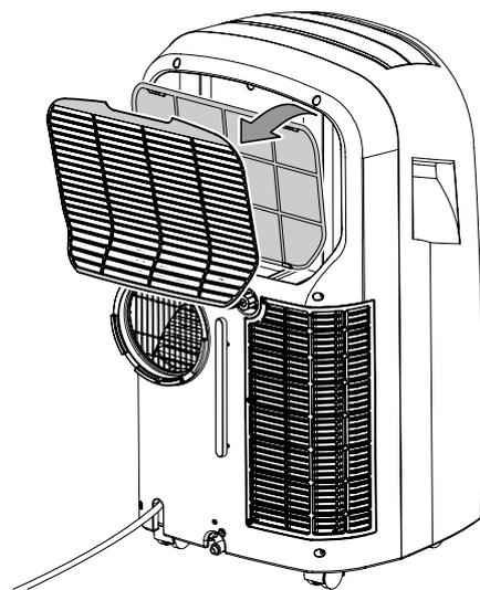
2. Säubern Sie den Filter mit einem weichen, fusselfreien, leicht angefeuchteten Tuch. Sollte der Filter stark verschmutzt sein, säubern Sie ihn mit warmem Wasser, vermischt mit neutralem Reinigungsmittel.
