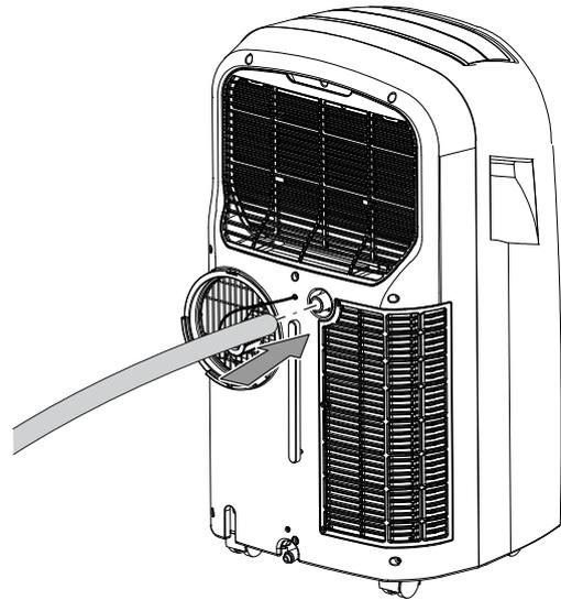
4. Führen Sie das andere Ende des Schlauches zu einem geeigneten Abfluss (z. B. Gully oder einem ausreichend großen Auffangbehälter). Der Kondensatablassschlauch darf nicht geknickt werden und darf zum Abfluss hin keine Steigung überwinden, da das Kondensat sonst nicht ablaufen kann.
