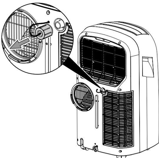
3. Verbinden Sie den Kondensatablassschlauch mit dem Schlauchanschluss (5).
