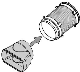
2. Verbinden Sie den Schlauchanschlussstutzen des Abluftschlauchs mit dem Anschluss Abluftschlauch (9) am Gerät.
