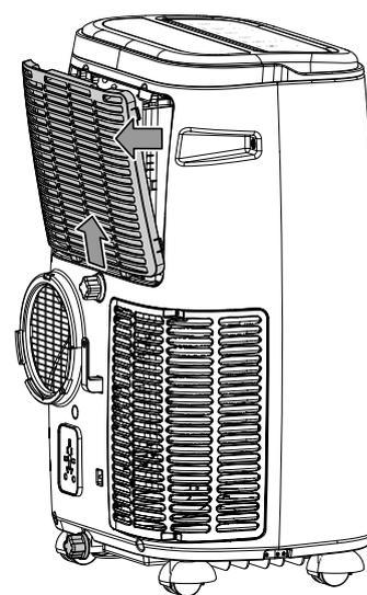
2. Säubern Sie den Filter mit einem weichen, fusselfreien, leicht angefeuchteten Tuch. Sollte der Filter stark verschmutzt sein, säubern Sie ihn mit warmem Wasser, vermischt mit neutralem Reinigungsmittel.
