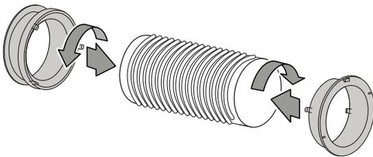
2. Verbinden Sie das passende Ende des Abluftschlauchs mit dem Anschluss Abluftschlauch (7) am Gerät.
