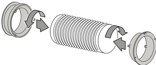
2. Raccordez l'extrémité adaptée du tuyau au raccord du tuyau d'évacuation d'air (7) sur l'appareil.
