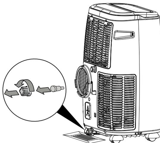
3. Laissez le condensat s'écouler.
