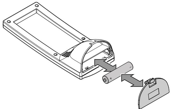
3. Schließen Sie das Batteriefach.
