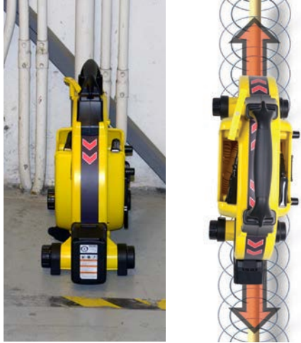
Kuva 4 – Induktio RIDGID SeekTech ST-33QR-laitteella
