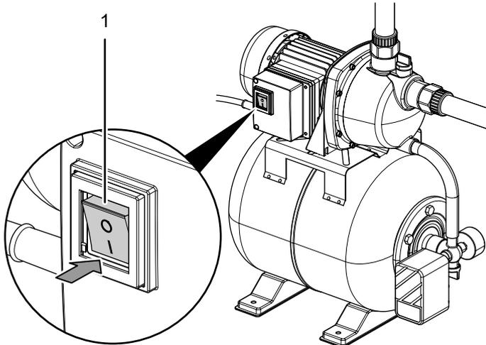
⇒ O aparelho está pronto para o uso e liga-se quando a pressão de ativação cai abaixo de 1,5 bar devido à queda de pressão no sistema - geralmente ao abrir um consumidor na linha de pressão.
