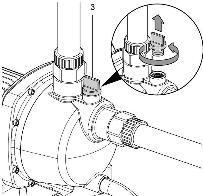
2. Encher o aparelho até ao canto superior com o meio bombeado por meio do bocal de enchimento de água (3). Também a linha de sucção conectada devia ser abastecida por completo com o meio bombeado.
