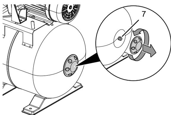
5. Verificar a pressão de pré-compressão por meio de um medidor de pressão de ar na válvula do autoclave (7). Esta deve ser de 1,5 a 1,8 bar.
